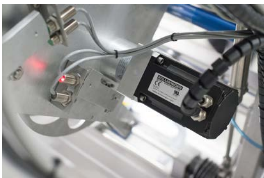
Antriebslösung im Etikettierer einer Verpackungsmaschine mit AKM31K
