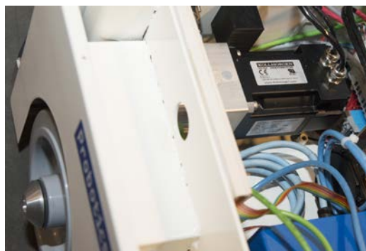
Niederspannungsantrieb in einem autonomen Transportsystem. Mit Niederspannungs Servoachsen ausgerüstete autonome Transportsysteme zeichnen sich durch hohe Präzision und dynamisches Fahrverhalten aus.
