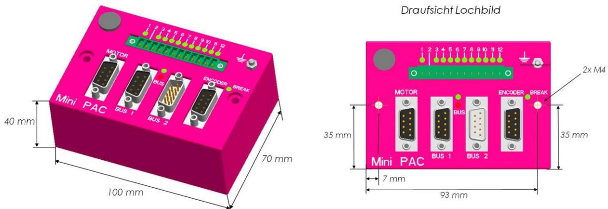
Für die Hutschienenmontage wird das Gerät mit einem Kühlkörper geliefert. Bei anderer Montageart gilt nachfolgende Einbauvorschrift.
