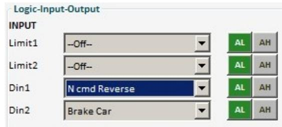
Bei Din2 eingeschaltet = erhöhtes Bremsmoment
