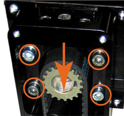
Abbildung 22: Zahnriemenspannung lösen
